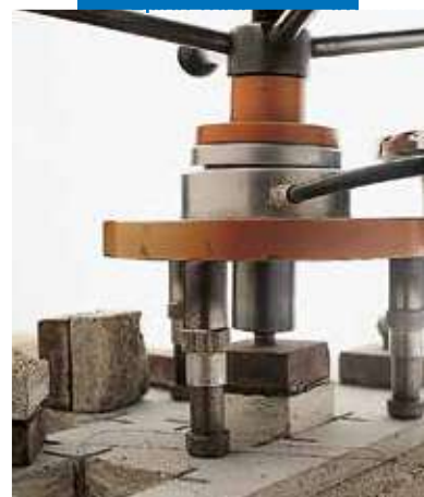
Meranie ťahovej prídržnosti malty (SATTEC)
