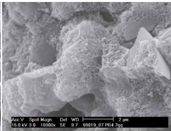
Obr.4 Mikroskopický záber na MAPE-ANTIQUE po 8 dňoch „starnutia“. Všimnite si zagulatenú štruktúru, typickú pre stabilizovaný systém
