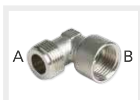
Gomito 90° M/F in ottone nichelato con filettatura maschio ISO 228 G a battuta piana (A) e filettatura femmina ISO 228 G (B)
