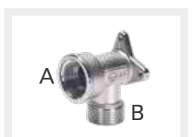
Gomito a fissaggio M/F in ottone nichelato con filettatura maschio ISO 228 G a battuta piana (B) e filettatura femmina ISO 228 G (A)
