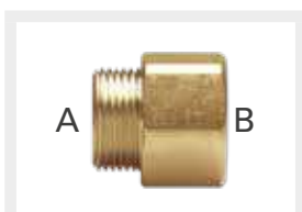
Nipplo M/F in ottone con filettatura maschio ISO 228 G a battuta piana (A) e filettatura femmina EN 10226 Rp (B)
