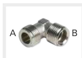
Gomito 90° M/M in ottone nichelato con filettatura maschio ISO 228 G a battuta piana (A) e filettatura maschio ISO 228 G con sede per tubo rame De 14 (B)
