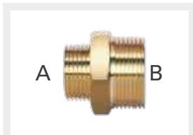
Nipplo ridotti M/M in ottone con doppia filettatura maschio ISO 228 G a battuta piana (A-B) Brass M/M reduced nipples with double ISO 228 G male thread with plane end (A-B)
