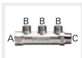
Collettori lineari a tre vie in ottone nichelato con filettatura maschio ISO 228 G a battuta piana (B)
